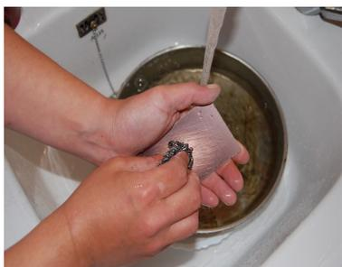
A l'aide d'un Boulinox (une boule gratton en inox) mais j'adore le nom. Frottez énergiquement la surface pré-sensibilisée.
